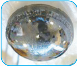
चित्र 1 : (क) सिलिकॉन कार्बाइड बूल तथा (ख) सिलिकॉन कार्बाइड वेफर। (स्रोत : इंटरनेट)
