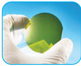
चित्र 1 : (क) सिलिकॉन कार्बाइड बूल तथा (ख) सिलिकॉन कार्बाइड वेफर। (स्रोत : इंटरनेट)
